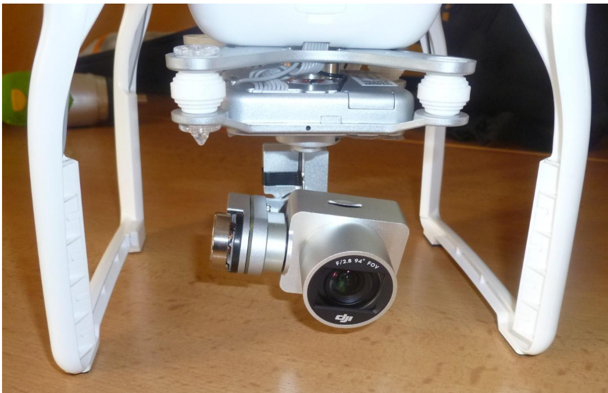
Obr. 5 Detail použité kamery s rozlišením 4K včetně gimbalu (závěsu kamery)
