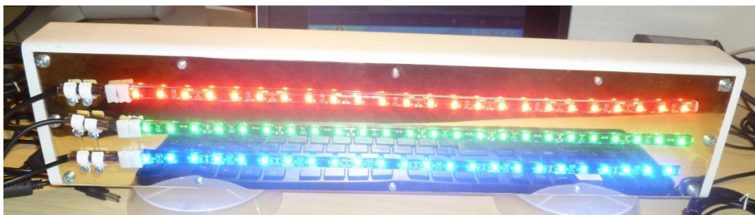
Obr. 10 Provedení montáže pásek LED (červený, zelený a modrý)
