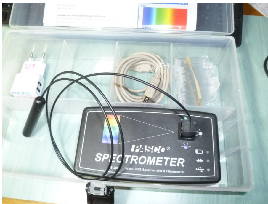
Obr. 9 Použitý spektrometr PASCO PS-2600 (s optickou sondou)
