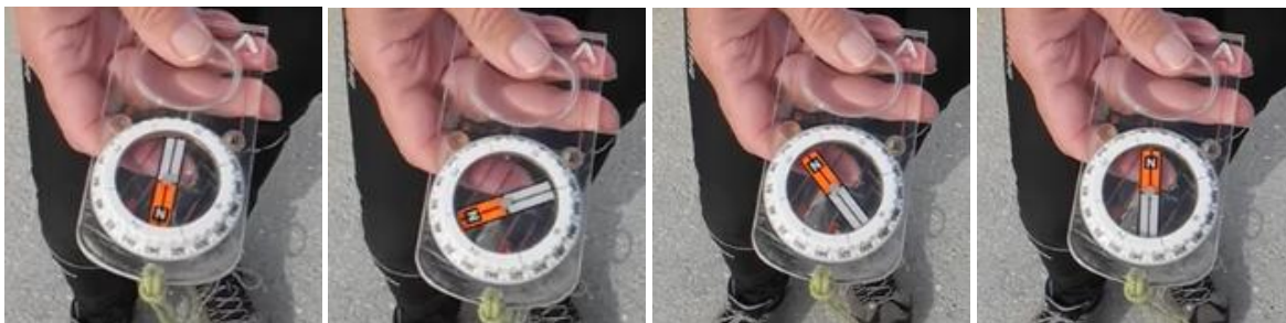
Obr. 7: Po sklonění severního konce střelky k zemi se střelka otočí o 180^\circ .
