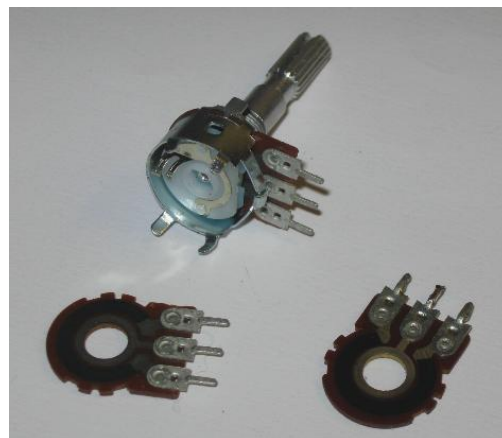
Obr. 8 Nahrazení odporové plošky ve stereo potenciometru
