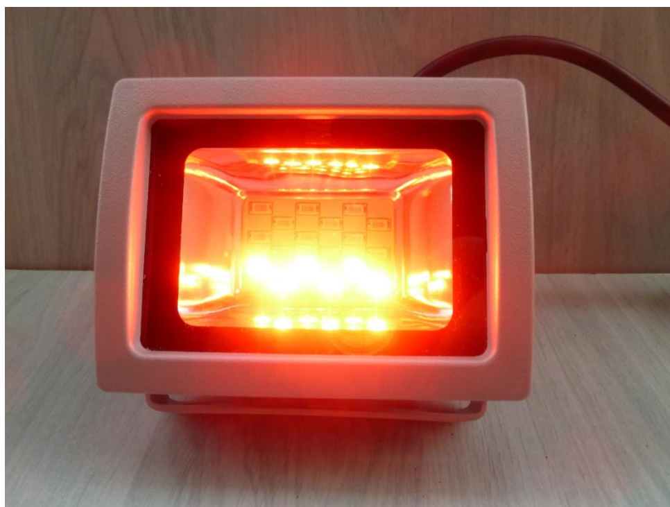
Obr. 25 Červené ledky kompaktního dálkově řízeného světla RGB LED
