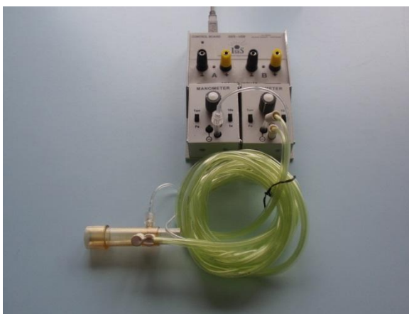
Obr. 3. Snímač s Pitotovou trubicí (autor)
