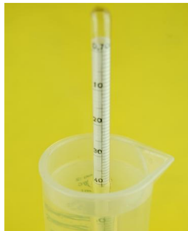
Obrázek 10. Detail na stupnici areometru.
