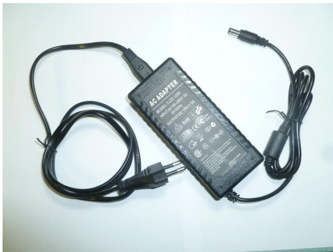
Obr. 3 Síťový adaptér 12V/5A pro napájení pásků LED
