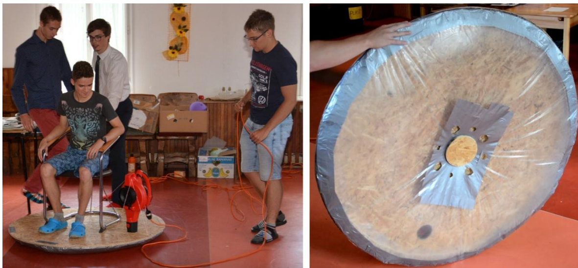
Obr. 6: Funkční vznášedlo a pohled na jeho spodní stranu
