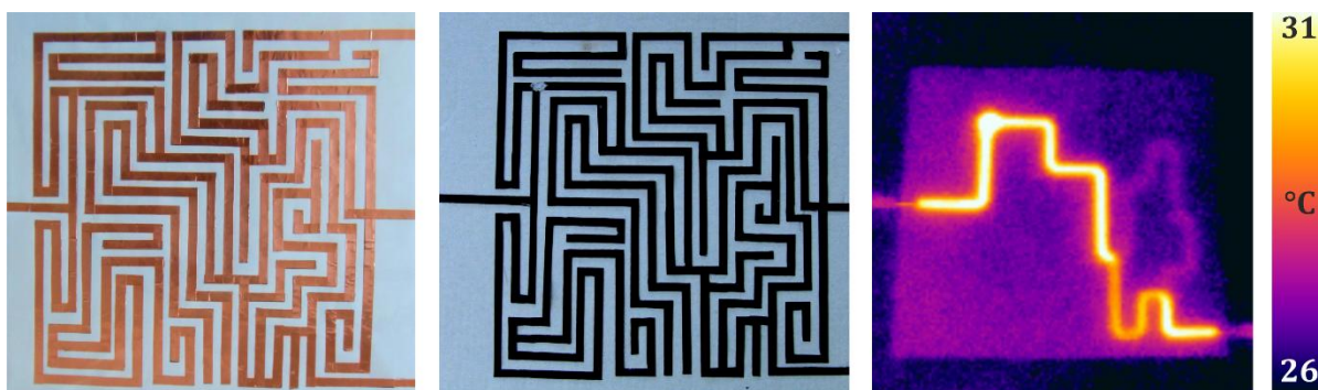
Obr. 1. Vlevo nefunkční bludiště z měděné pásky, uprostřed bludiště z kaptonové fólie a vpravo jeho termografický snímek po připojení napětí 40 V DC. Na termografickém snímku je patrné rozvětvení obvodu (v pravé dolní části) a také místo, kde byl obvod omylem rozstřížen a poté opraven vodivou pastou (jasně svítící bod vlevo nahoře).
