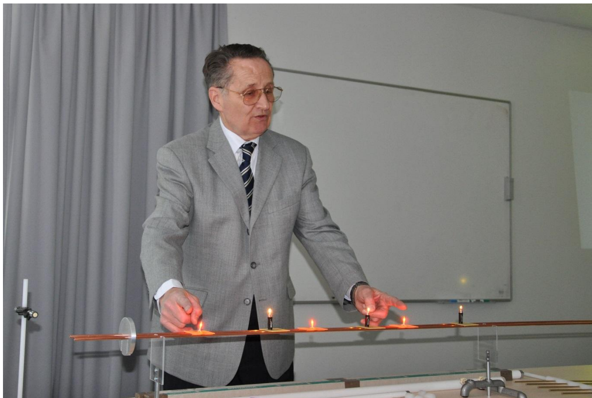
Obr. 4 Kmitny proudu a napětí na vedení zakončeném zkratem
