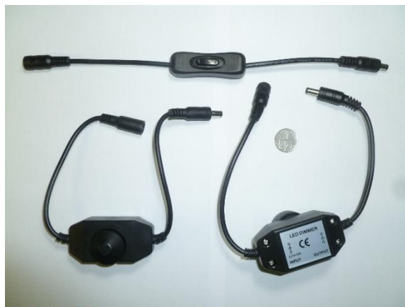
Obr. 5 Mezišňůrový vypínač a dva elektronické (bezztrátové) potenciometry
