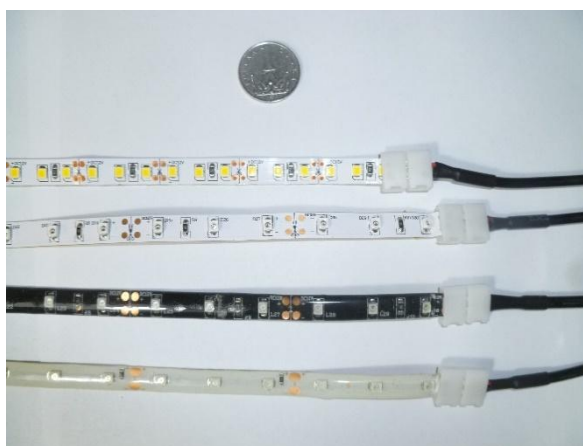
Obr. 6 Ukázka konstrukce jednobarevných LED pásek v porovnání s mincí 1 Kč. Horní dva pásy jsou běžného provedení, spodní dva jsou voděodolné (např. osvětlení akvária)
