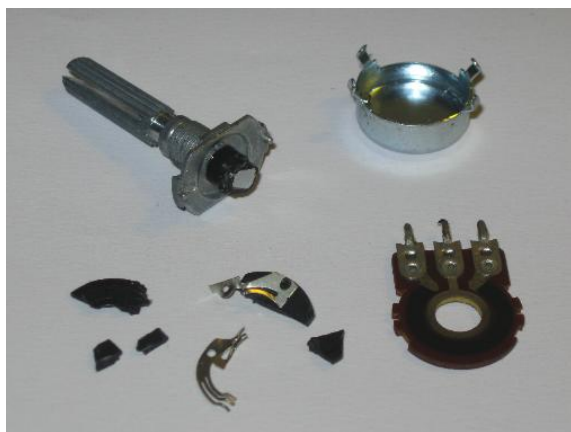
Obr. 7 Vymontovaná odporová ploška 10k
