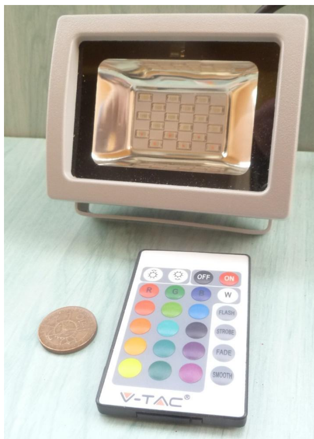
Obr. 22 Porovnání velikosti infračerveného dálkového ovladače a kompaktního světla RGB s mincí 10 Kč
