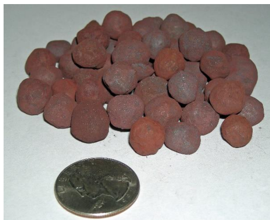
Obrázek 12.5. Pelety vyrobené ze železné rudy a srovnání s velikostí mince (čtvrtdolarem)
